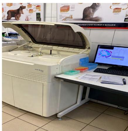
**Рис. 1.** Автоматический биохимический анализатор EOS BRAVO v.200
