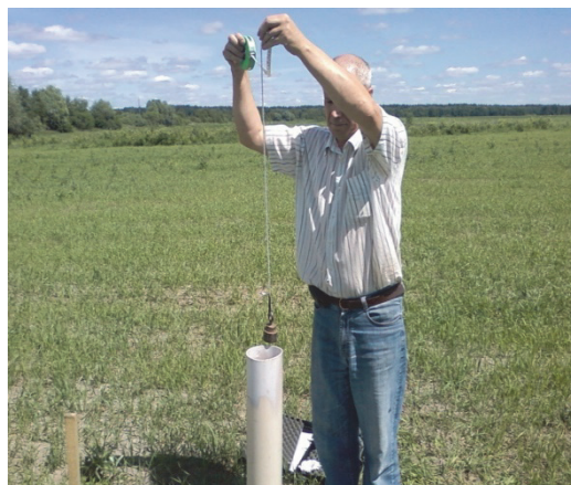
Рис. 2. Измерение УГВ с использованием хлопушки
