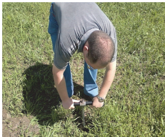
Рис. 1. Очистка открытой скважины перед измерение УГВ
