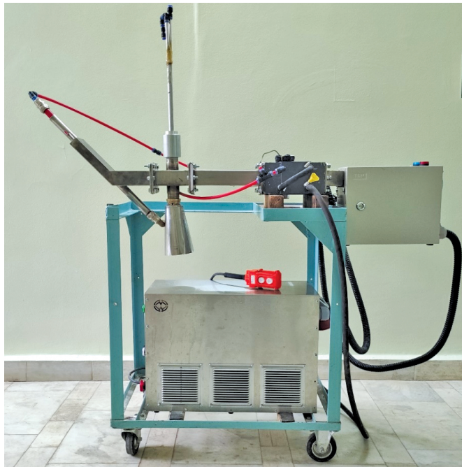
Рис. 1. Источник СВЧ плазмы с коническим концентратором
