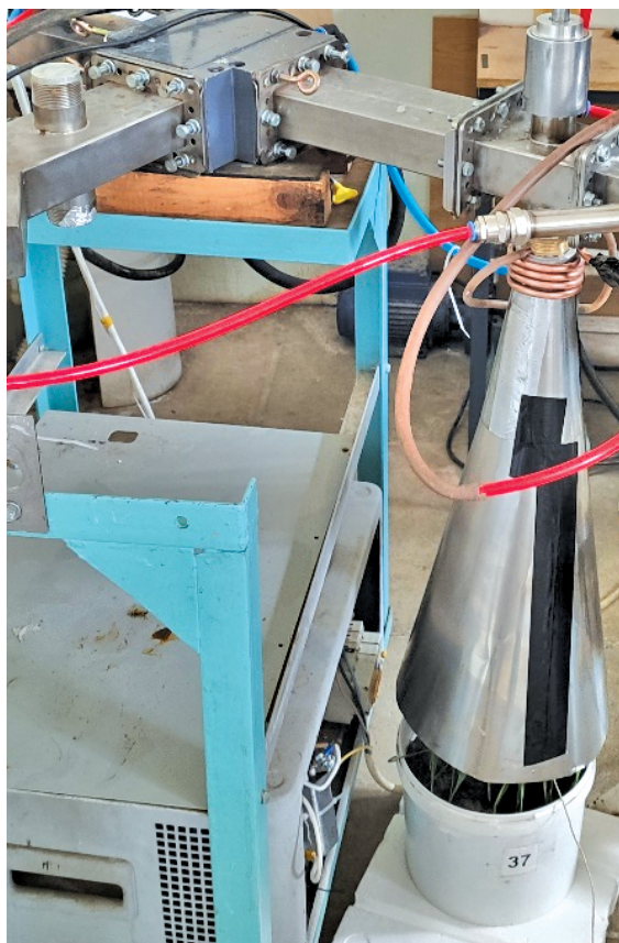
Рис. 2. Процесс обработки растений СВЧ плазмой Fig. 2. The process of treating plants with microwave plasma
